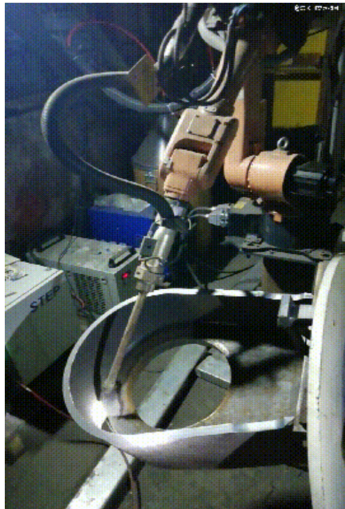
应用：高压寻位+变位机协同+电弧跟踪
